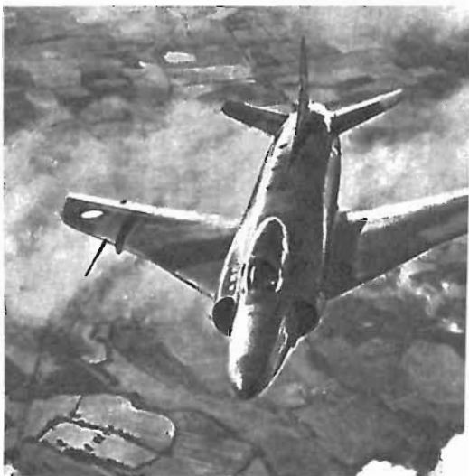
Il Fairey F. D. 2 , aereo sperimentale che supera agevolmente il muro del suono in volo orizzontale, ha la sagoma di un pesce spada. Il suo lungo naso può essere abbassato durante l'atterraggio per consentire una maggiore visibilità al pilota.
